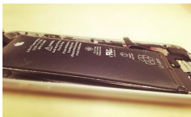
Abbildung 1: Aufgeblähter Lithium-Ionen-Akkumulator (Quelle: SGU)
